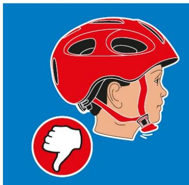
1. **Helm aufsetzen, Kopfring festziehen und Gurtband unter dem Kinn schließen. Die Helmschale mit beiden Händen ergreifen und zur Seite drehen. Der Kopf muss sich sofort mitbewegen.**
